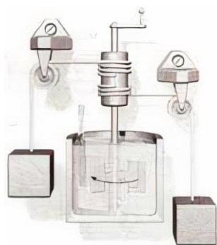
Figura 2 - Diagrama esquemático para o experimento de Joule.
